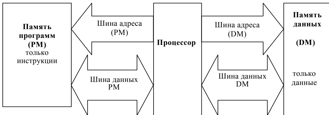
Рис. 7. Структура компьютера с гарвардской архитектурой
