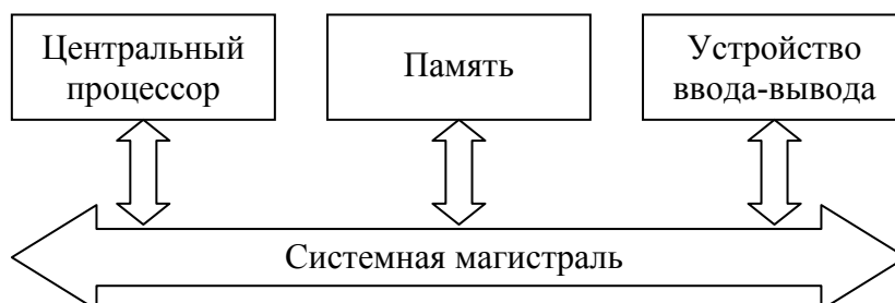
Рис. 5. Магистральная структура ЭВМ
