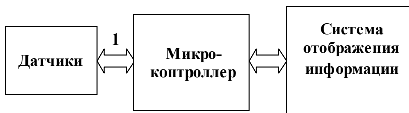
Рис. 9. Структура автономной контрольно-измерительной системы
