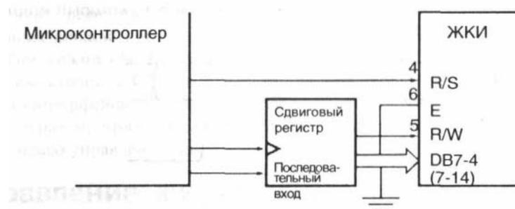
Рис. 16. Использование сдвигового регистра для подключения ЖКИ
